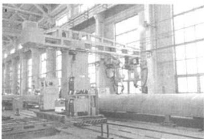
图 19 碳钢车体车顶焊接机器人
