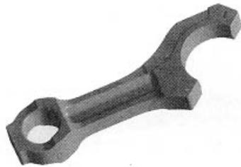
图2 280柴油机连杆三维造型图
