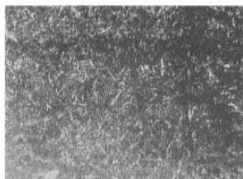
图 6 止动簧经淬火和回火处理后的金相显微组织 \times 500
