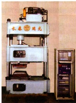
图11 630kN精密多点成形压力机
