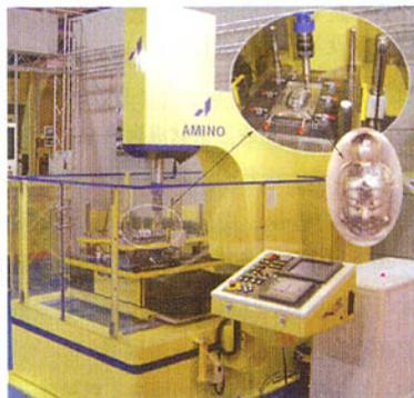
图5 日本网野公司的板材无模成形机床
