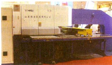
图1 扬力集团的 $\alpha$ 30型数控转塔冲床
