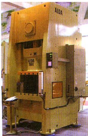
图4 会田工程技术(上海)有限公司 NS2—1600D型伺服压力机
