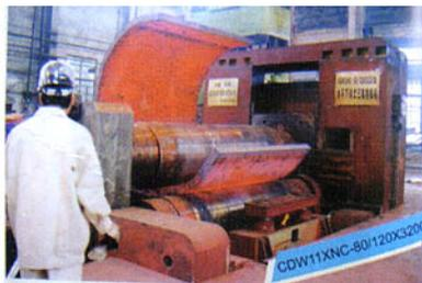
图8 冷、热卷水平下调式三辊卷板
