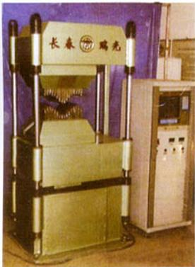
图10 200kN快速调形式多点成形压力机
