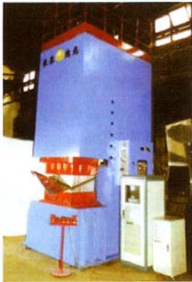
图9 2000kN快速调形式多点成形压力机
