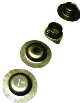
图1 TD处理后的模具加工出的工件
