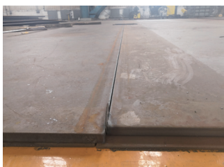
图4 30mm以内钢板不开坡口拼焊
