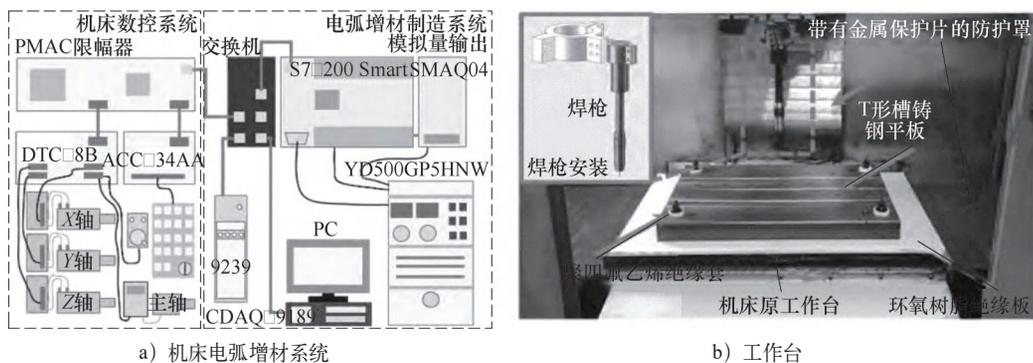
图4 机床电弧增材设备构成<sup>[21]</sup>
