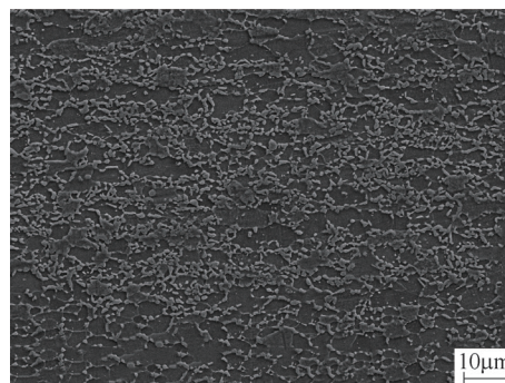
图1 1#试验钢的的电镜组织
