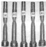
图4 焊钉拉伸试验
