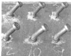
图3 焊钉弯曲试验
