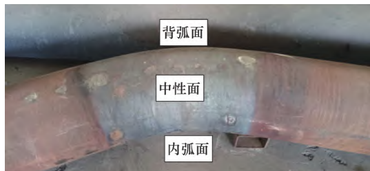
图2 WB36钢中频感应加热弯后成形状态
