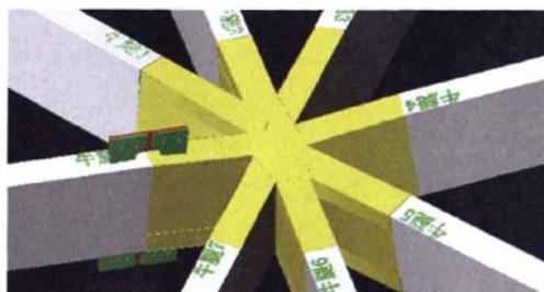
图6 阳光谷钢结构典型节点
