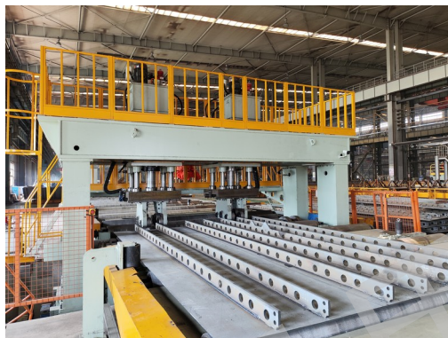
图 6 板单元数控冷矫正机床工作实景
