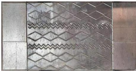
图3 激光熔覆耐磨板整体形貌
