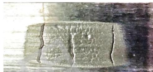
图 7 磨损试样磨损后形貌
