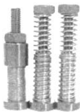
图2 弹簧应力松弛试验螺栓螺母周期作业法
