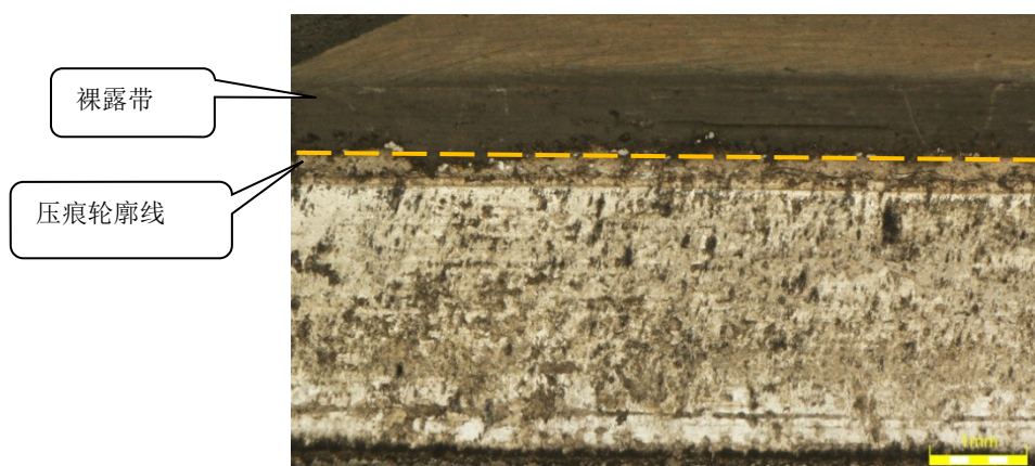
图5 榫头侧表面镀银层形貌
