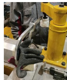
图 5 端部横梁刚性固定
