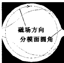
图7 轴颈内磁场和缺陷分布
